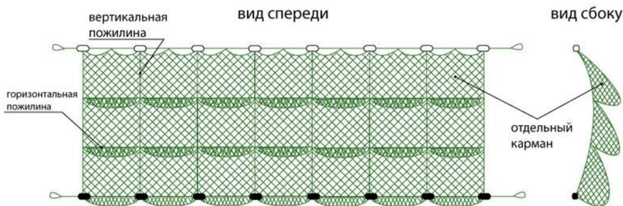
Рис. 1. Устройство стандартной паутинной сети
